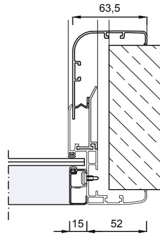
Dettaglio B telaio angolare
