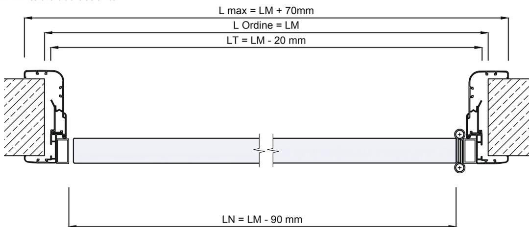
Dettaglio A telaio abbracciante 63,5
