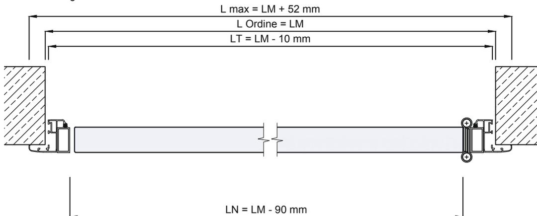
Dettaglio A telaio angolare
