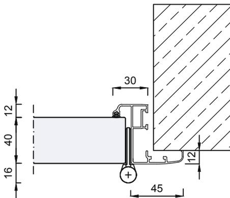
Dettaglio B telaio abbracciante
