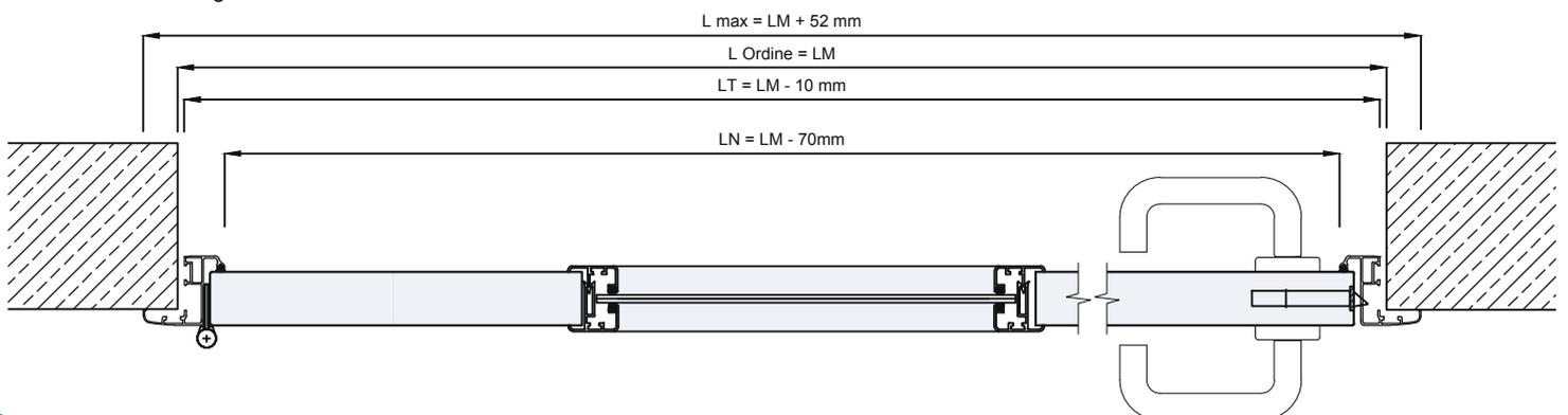
Dettaglio A telaio angolare
