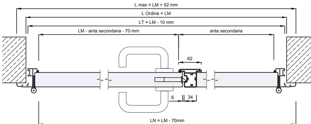
Dettaglio A telaio angolare
