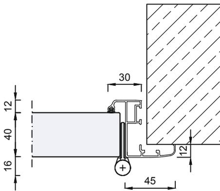
Dettaglio B telaio abbracciante
