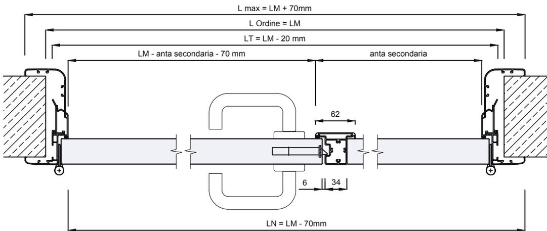
Dettaglio A telaio abbracciante
