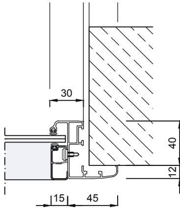
Dettaglio A telaio abbracciante
