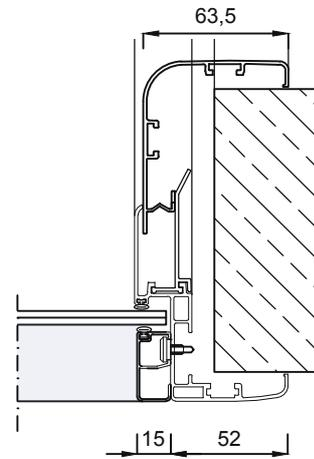
Dettaglio B telaio angolare
