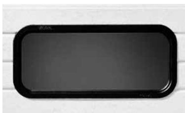
Variant 5 Rettangolare, largo, con vetro trasparente in doppia lastra acrilico* Dim. Interno telaio 651 x 251 mm Dim. Esterno telaio 726 x 326 mm.
