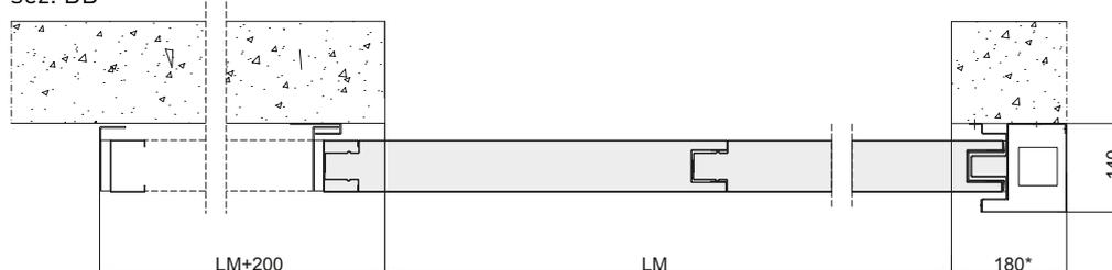
\* Misure per portoni con  $HM > LM$ . In caso di  $HM < LM$ , l'ingombro del contrappeso varia da 181 a 340 mm.
