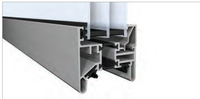
Plexiglas Optical con tripli vetri 40 mm (4-14,75-2,5-14,75-4 mm)
