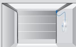
Comando apriporta inserito nella guida destra del portone. Centralina di controllo direttamente accanto al portone in corrispondenza dell'arresto meccanico laterale.
