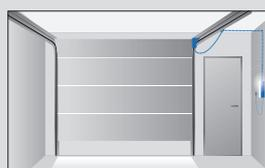
Se l'arresto meccanico laterale fosse incorporato, ad esempio mediante una porta pedonale laterale, è possibile utilizzare una prolunga per cavo.
