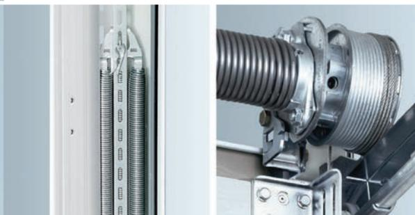
Dotato di kit molle di tensione verticali o albero a molla di torsione orizzontale, completo di dispositivo di sicurezza contro la rottura delle molle, a norma DIN EN 12604.
